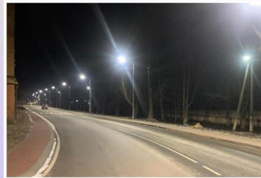
У результаті на ділянці вулиці протяжністю **500 м** встановлені нові 22 оцинкованих опори з LED – лампами, потужністю 120 Вт кожна.
